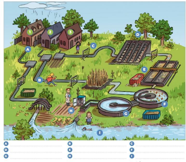
Réponse : la maison 3. A = égouts, B= collecteur, C= dégrillage, station de pompage, D = relevage, E = dessableur \ déshuileur, F = bassin biologique, C = clarificateur ou décanteur, H = venturi et l'échantillonneur, l = cours d'eau
